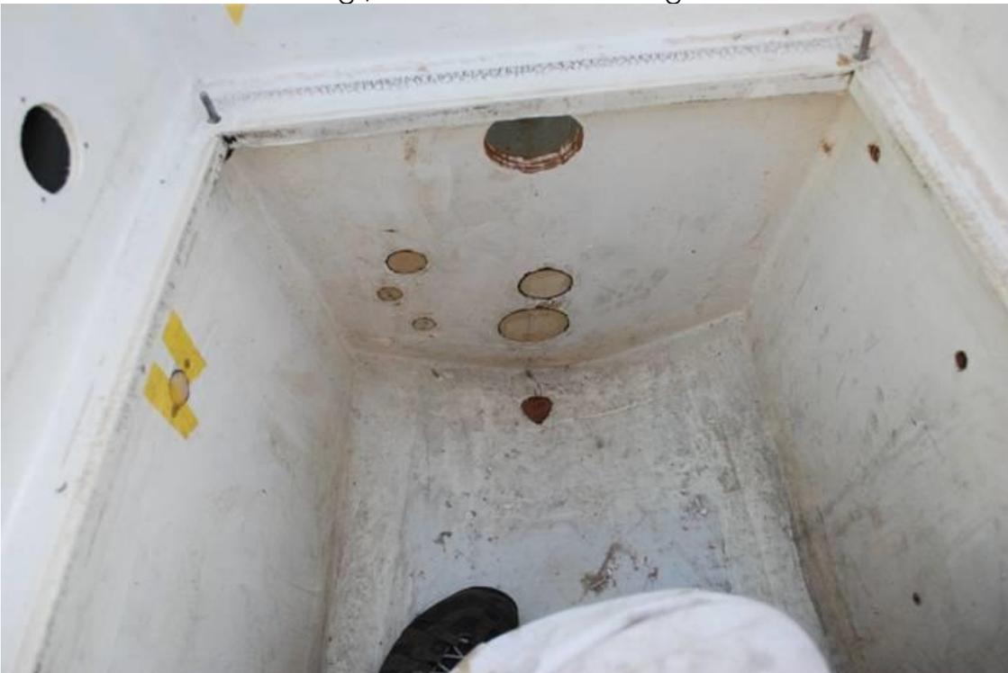
Kräutler Unterwasserteil montiert auf dem gleichen Fundament. Das Programm für das Lochbild, das gemäss der Yamaha Grundplatte gefertigt wurde, müsste bei Kräutler vorhanden sein. Schrauben möglichst lang, aber nicht unten anstehend:
