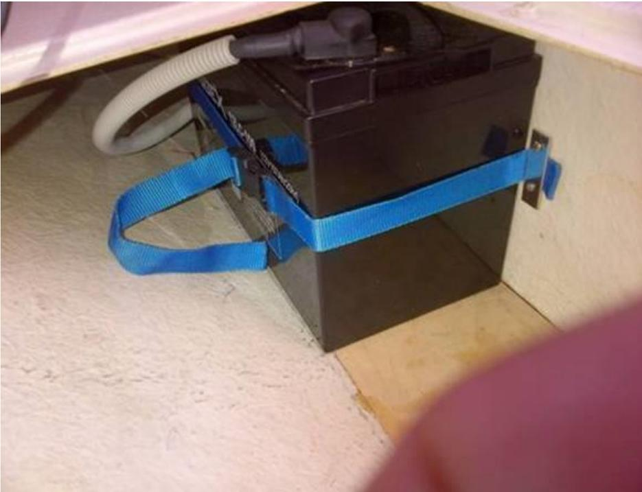
Ladegerät Waeco 24 V / 15 A Steuerbord hinten. Mit Abluftkanal in die Heck Box.
