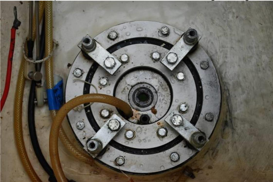
Der Kräutler Unterwasserteil passt ohne GFK - Arbeiten in den bestehenden Schacht!
