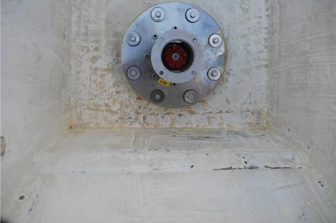
Aufgesetzter Motor, der Motorraum ist sozusagen „leer“, mit Gelcoat neu beschichtet – Freude herrscht - auch bei den Prüfungsexperten! Die Elektronik Kabel sind noch nicht angeschlossen. Die Trennwand vorne zum Innenraum hin, ist wasserdicht zu laminiert.
